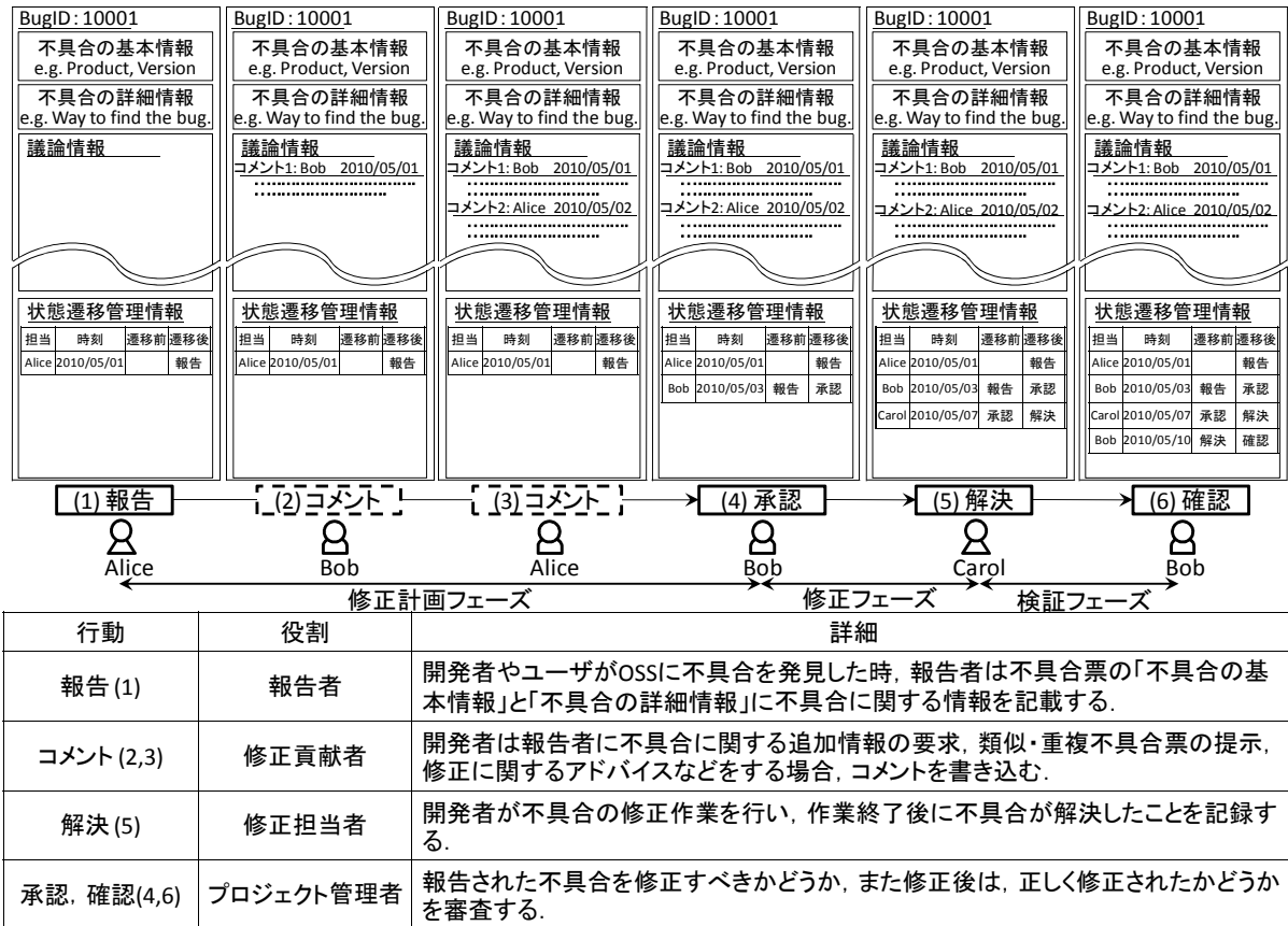
図1 BTS を用いた不具合修正の流れ
